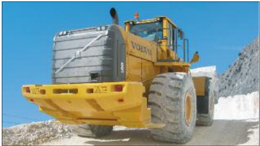
■ Il treno di potenza della L350F BH-HD nelle applicazioni per cave di marmo è di tipo "Heavy Duty"
