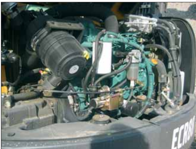
■ Il motore dell'ECR88 è in grado di attivare la funzione Auto-Idling di riduzione al minimo dei giri quando l'attrezzatura è in condizioni di sforzo
