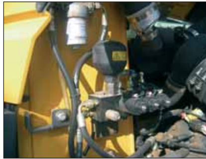
■ La pompa di iniezione si avvale del sistema Cold Control di regolazione meccanica della temperatura
