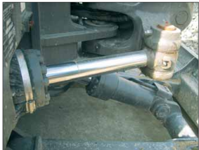
■ Il sistema Kick Down controlla la velocità di trazione in funzione della coppia resistente sulla lama
