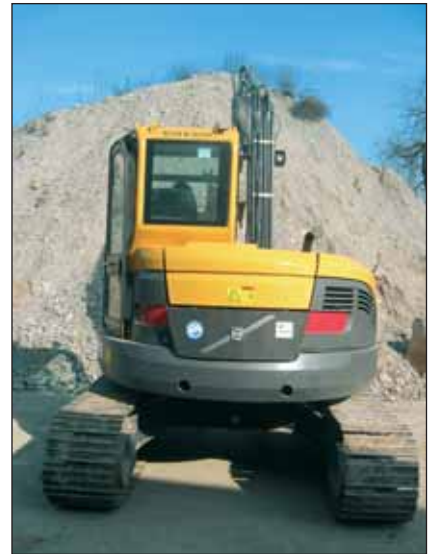
■ Dimensioni minime, grande capacità: l'ECR88, nella versione Plus, incrementa la sua stabilità su terreni difficili, grazie al sottocarro a X
